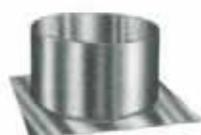
Fixé sur et/ou sous un plancher ou de part et d'autre d'une cloison (CI-50), il sert à positionner le conduit lors de toute traversée de plancher, dalle ou solive, permettant de maintenir un espace minimal de 50 mm (2 pouces) entre l'enveloppe extérieure du conduit et les matériaux combustibles traversés. En aucun cas un joint d'assemblage ne devra être positionné dans une traversée de mur ou de plancher.
