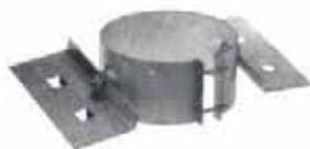
Support de complément fixé le plus souvent à une charpente. Deux platines orientables sont vissées sur la charpente et s'adaptent à la pente du toit. Un collier de serrage solidaire de ces platines est bloqué sur la cheminée et sécurisé par des vis auto-taraudeuses (fournies). (Se référer au tableau Capacité de charge, p. 6). Fabriqué en acier galvalume.
