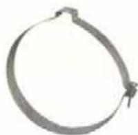
Stabilise et supporte le conduit **CI** lorsque utilisée en raccordement horizontal. Permet la suspenste du conduit **CI** en utilisant une tige filetée fixée au plafond de la chaufferie ou en tout autre point. Nécessaire tous les 2 m (6.6 pi) ( pour conduit **CI-25** ou **CI-50**). Fabriquée en acier inoxydable (BDSC). Aussi disponible en galvalume (BDSE).
