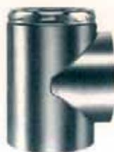
Situé le plus souvent à la base du conduit, il permet le raccordement à l'appareil. Il peut être installé en tout point du parcours horizontal ou vertical pour constituer un branchement ou pour assurer l'inspection et le nettoyage de l'installation. Peut être utilisé pour raccorder un carneau permettant l'installation d'une clé de tirage. Livré avec un tampon d'inspection (TV). (Se référer au tableau Capacité de charge, p. 6).
