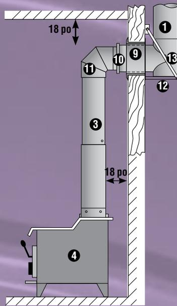
Installation à travers le mur
